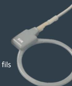
Antenne de transfert d'énergie
